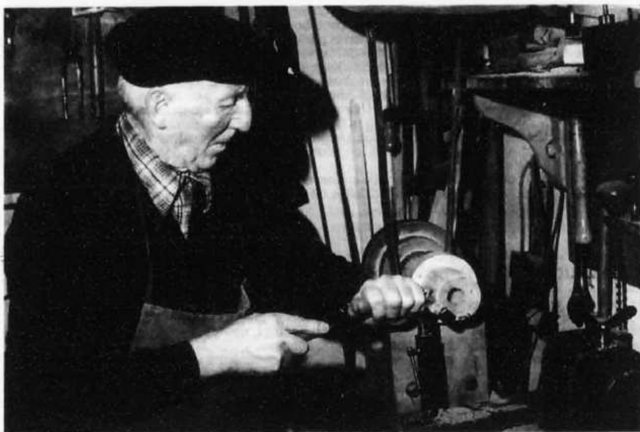
Le tour à bois servant à façonner mandrins, cadrans gradués et boutons molletés, n'a guère été modifié depuis septante-cinq ans, sauf son entraînement qui, à l'origine, se faisait au pied par l'intermédiaire d'un volant et d'une courroie de corde. (Photo prise en 1980).
