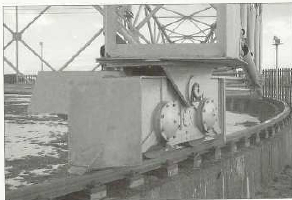
Photo 3: Un des deux chariots supportant 60 tonnes. On voit que ce n'est pas du bricolage
