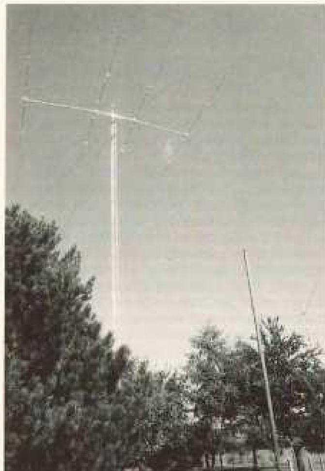
Beam 40 m. et Quad 5 bandes, 3 éléments
