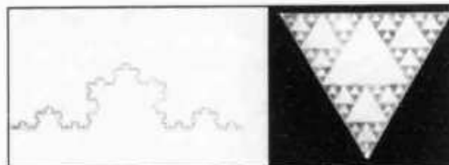
A gauche, une courbe de Koch et à droite, un triangle de Sierpinski réalisés sur circuit imprimé par l'équipe de Carles Puente de l'Université Polytechnique de Barcelone.
