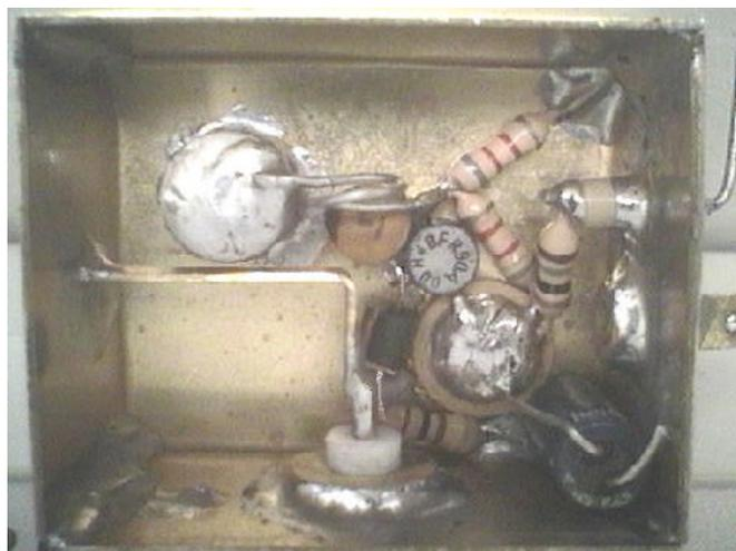
Les pattes de base et d'émetteur du BFR90A devront être coupées à 1 mm et toutes les liaisons maintenues aussi courtes que possible, comme on peut le voir sur la photo. Le collecteur du transistor devra être soudé le plus près possible du condensateur à pastille. La ligne de prélèvement de la HF devra être soudée à 1 mm de distance du corps du condensateur Tekelec (voir photo).
