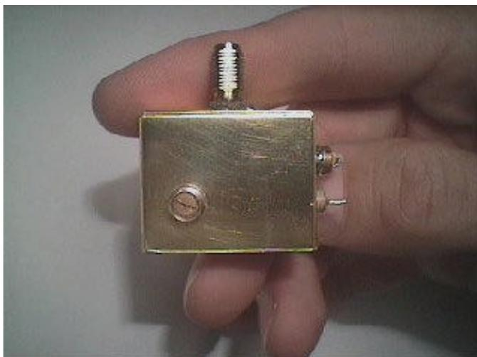
Le projet décrit vous permettra, sans trop de travail et pour une dépense minimale, de réaliser un oscillateur HF utilisable comme oscillateur local pour mon convertisseur ATV pour la bande de 2,4 GHz. Le circuit n'utilise qu'un seul transistor et quelques composants passifs. La réalisation pratique ne comporte aucune difficulté, même pour les moins expérimentés, à condition de suivre à la lettre la démarche décrite. La fréquence est accordée au moyen d'un condensa-
