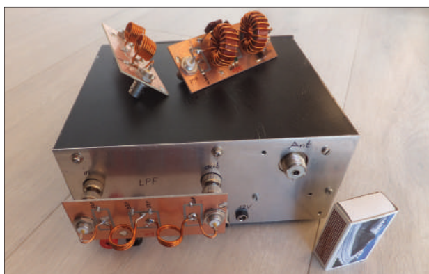
Bild 4: Rückseite der PA mit aufsteckbaren LPF. Masse: Breite = 20 cm, Höhe = 9 cm, Tiefe = 20 cm
