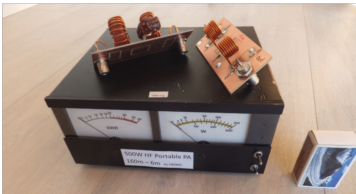
Die fertige Portabel-PA liefert bei 2,1 kg und 20x16x9 cm stolze 500 Watt von 160 m - 6 m
