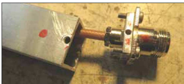
Pièce d'adaptation mécanique et prise châssis N avec coax RG-142
