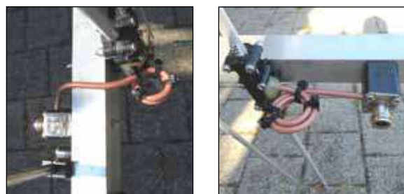
Fig. 4: On utilise le principe de transformation d'impédance par ligne quart d'onde ( \lambda/4 ).
