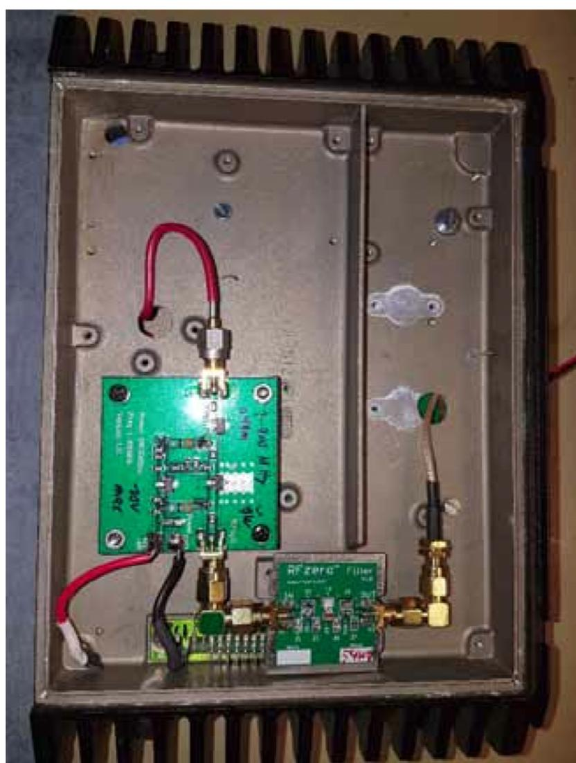
Côté du boîtier avec PA et le filtre passe-bas
