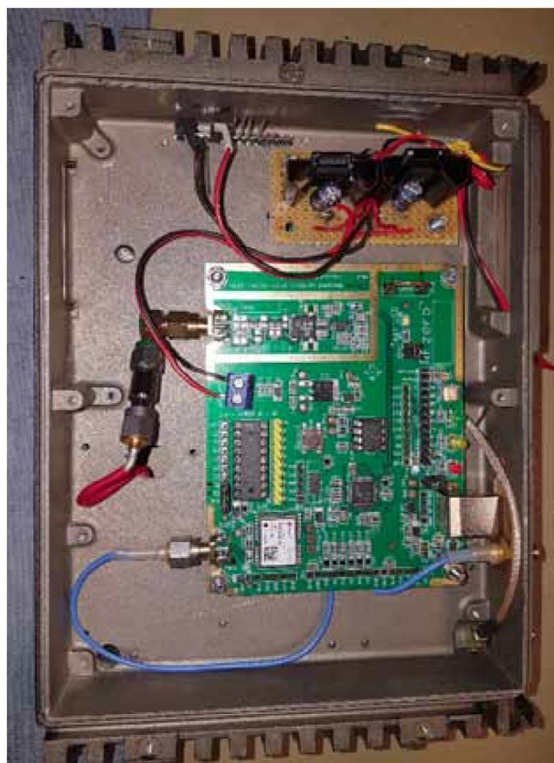
Côté du boîtier avec RFzero et le circuit d'alimentation
