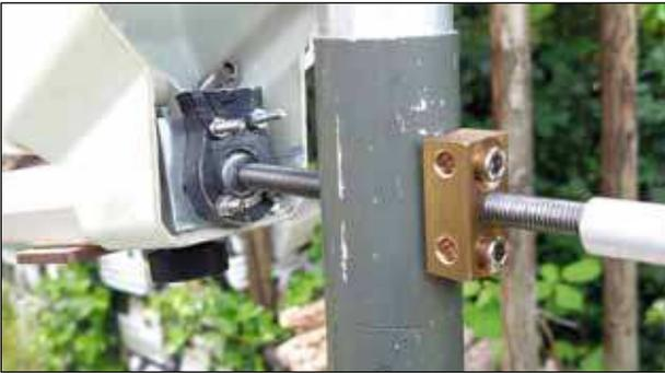
Réglage du site de la parabole - avec la butés-rotule de vampire
