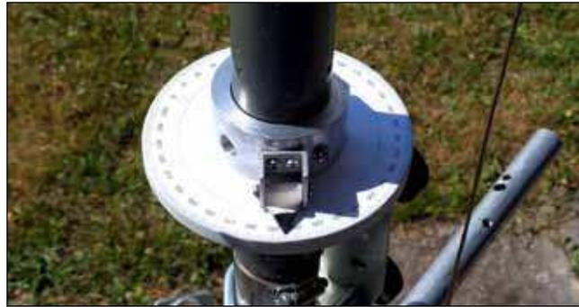
Rose des vents de réglage de l'azimuth
