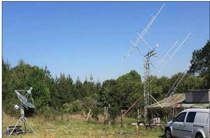
Parabole de 1m50, groupement de 4 antennes 144 MHz et de 2 antennes 432 MHz
