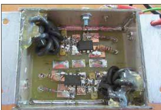
Bild 6a: Logarithmischer Verstärker (2x)
