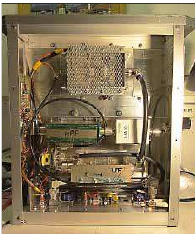
Fig. 7: L'intérieur de la boîte PA-LNA
