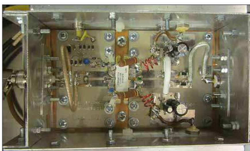
Fig. 2: platine PA LDMOS de W6PQL, dans son enclos avec la connectique
