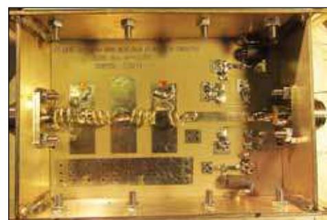
**Bild 4:** Tiefpass-Filter von W6PQL mit Richtkoppler
