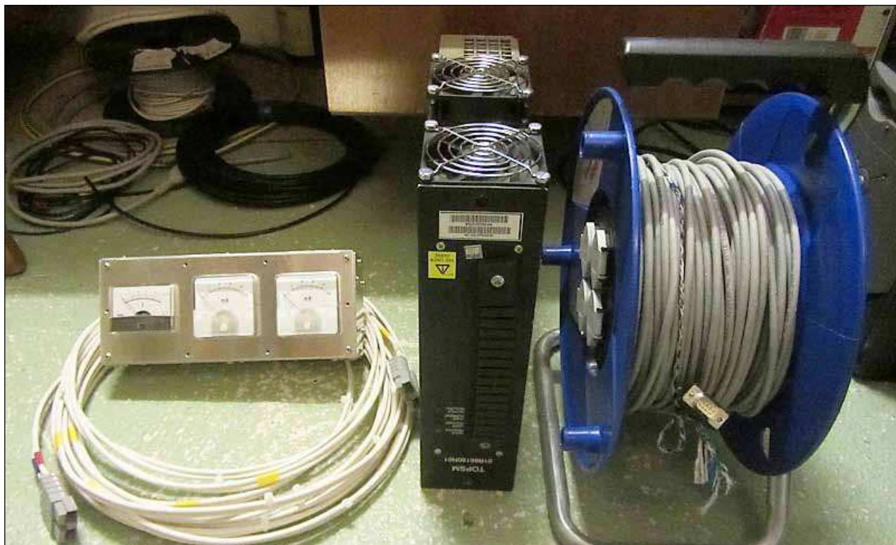
**Fig. 9: Boîte de contrôle, câble pour le 50V (blanc), alimentation 50V et câble de liaison (gris) entre le PA-LNA et la boîte de contrôle**
