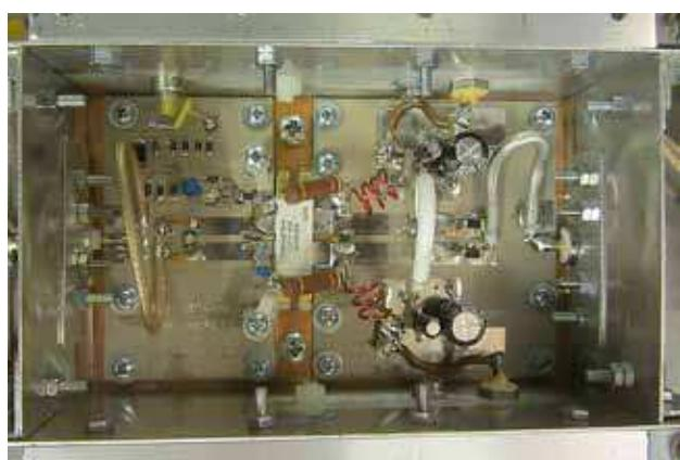
Bild 2: LDMOS PA von W6PQL in der Abschirmbox mit HF-Steckverbindern
