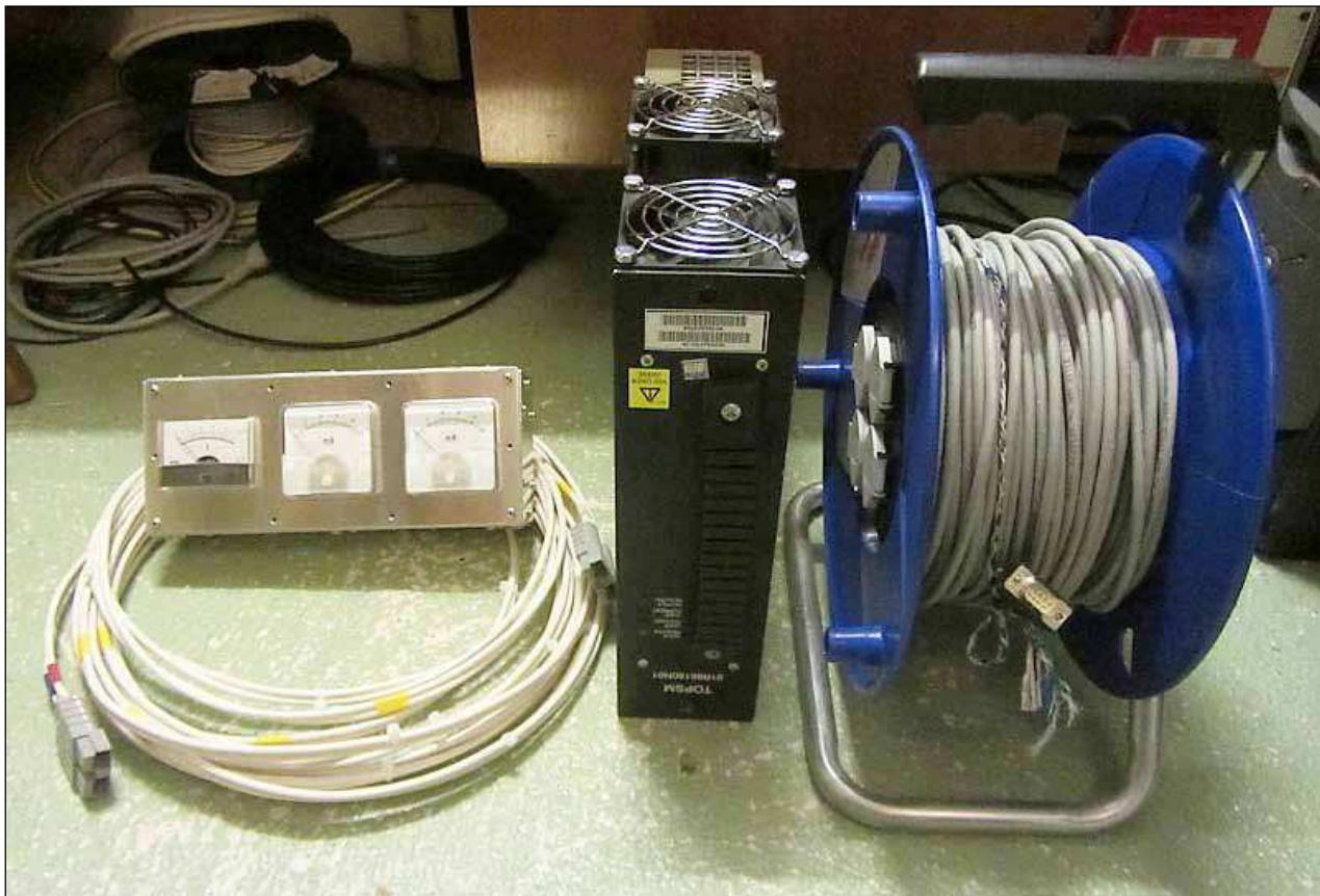
**Bild 9: Control-Box (Strom, Power, SWR), Kabel für 50V Speisung (weiss), 50V DC Speisegerät und Verbindungskabel (grau) zwischen PA-LNA und Control-Box**
