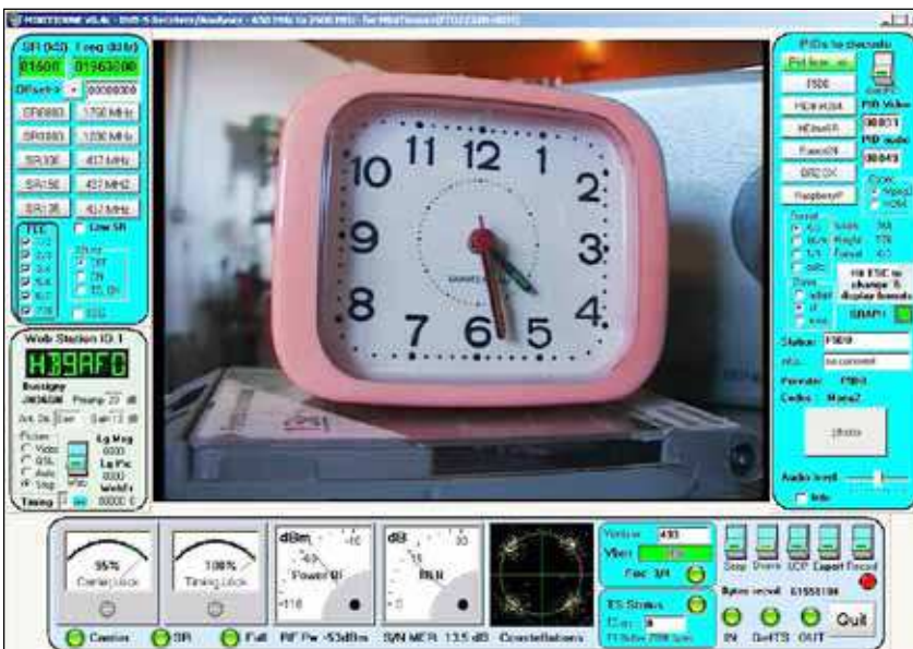
Le Minitouner reçoit les 70 mW émis par F5DB sur 437 MHz, à 60 km sans visibilité
