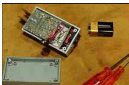
Photo 4: Le manip SANS son embase pour qu'il puisse rentrer dans mon petit boîtier
