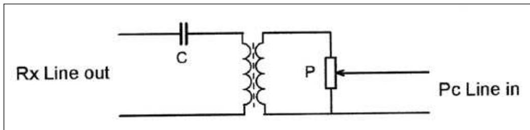
fig. 10 Séparation galvanique entre le Générateur et le PC. Évite les ronflements dus aux boucles de masse
