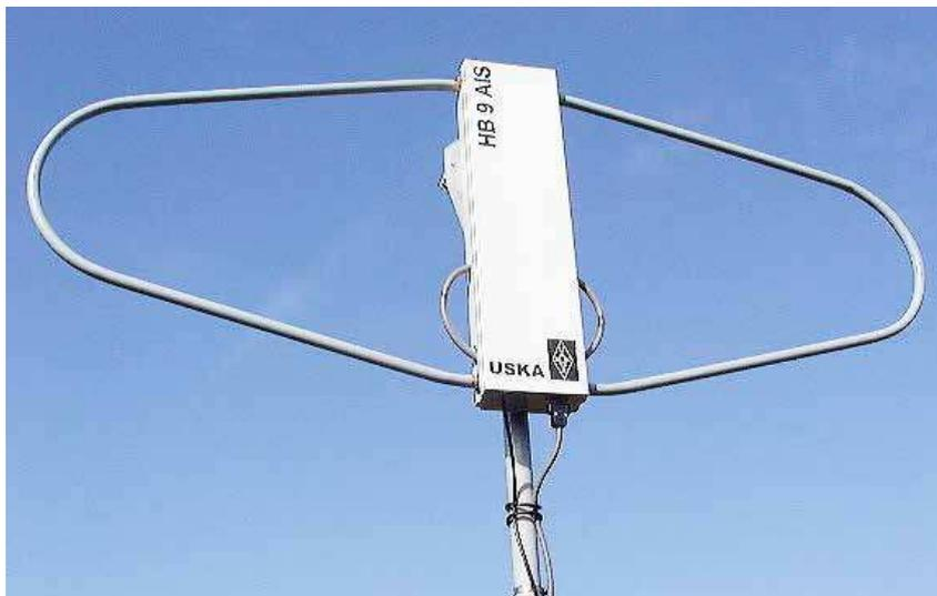
Le loop portable de HB9AIS pour 5 bandes HF
