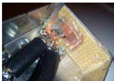
Zoom sur la capacité C3 construite sur Veroboard
