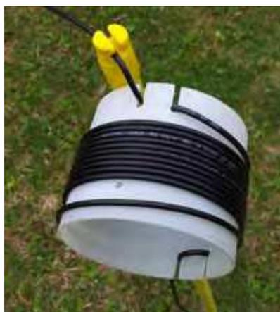
**Fig. 13:** Un type de coax Choke et ...
