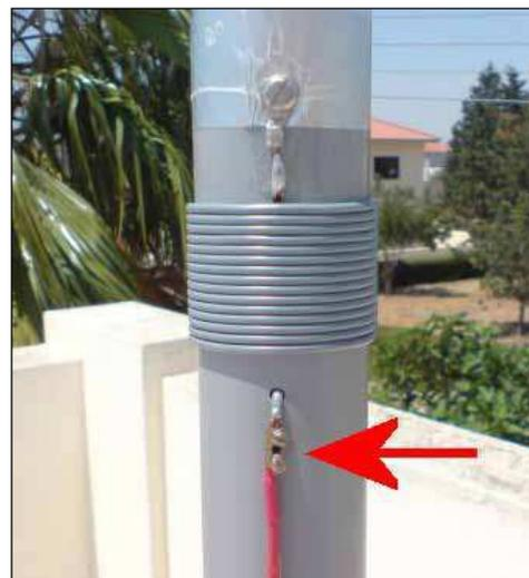
Bild 7: Der Pfeil markiert die Mitte des Dipols gemäss # 5 der Patentschrift
