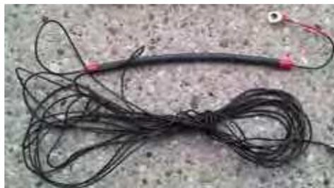
**Fig. 12:** L'alimentation Potter constituée par 10m de RG 174 et 20 perles ferrit CST 9,5/5.1/15-3S4 [9] emballées dans la gaine thermo-rétractable et renforcées dans les extrémités par un même matériel. Les perles seront dimensionnées de façon à coulisser librement sur le câble
