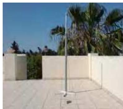
Bild 2: kapazitive Antenne für 20m
