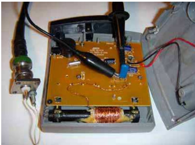
Illustration 4: Mesure de la fréquence de résonance à l'aide d'un générateur et un oscilloscope
