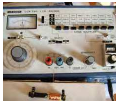
Illustration 3: Mesure de l'antenne à l'inductancemètre
