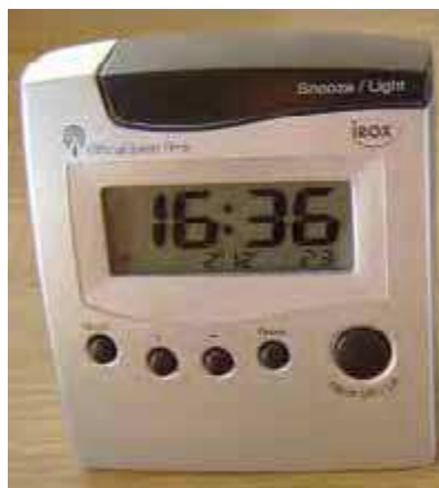
Illustration 2: Réveil radiocontrôlé sur HBG modifié pour DCF-77
