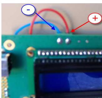
La polarité de branchement de l'alimentation est conforme à la photo ci-dessus. La carte est livrée sans connecteur ni fil de connexion. Cela permet à l'utilisateur d'installer le moyen de raccordement qui lui convient le mieux. A noter que la carte ne comporte pas de protection contre les inversions de polarité de branchement. Si cette dernière est incorrectement branchée, les dommages seront immédiats et irréversibles.
