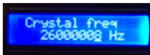
L'ergonomie pour ce réglage est identique au réglage de la fréquence de sortie de la source. Une pression sur la molette change le mode d'édition du curseur, la rotation de la molette déplace le curseur ou change le digit en cours d'édition. Une pression sur la touche WB ou NB termine cette commande.
