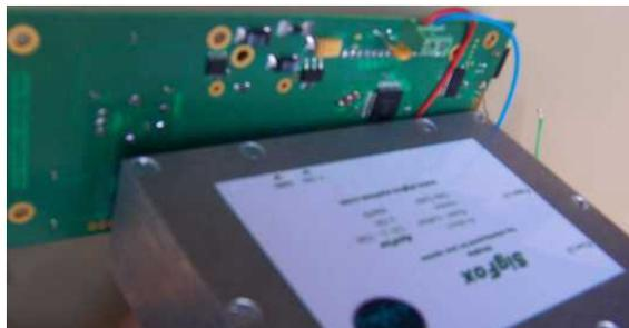
L'alimentation de la carte de contrôle est indépendante de celle du module SynFox. Toutefois, la même source de tension (12V) peut être utilisée pour alimenter les 2 dispositifs. A noter que la carte de contrôle supporte une tension d'entrée de 7V à 18V.
