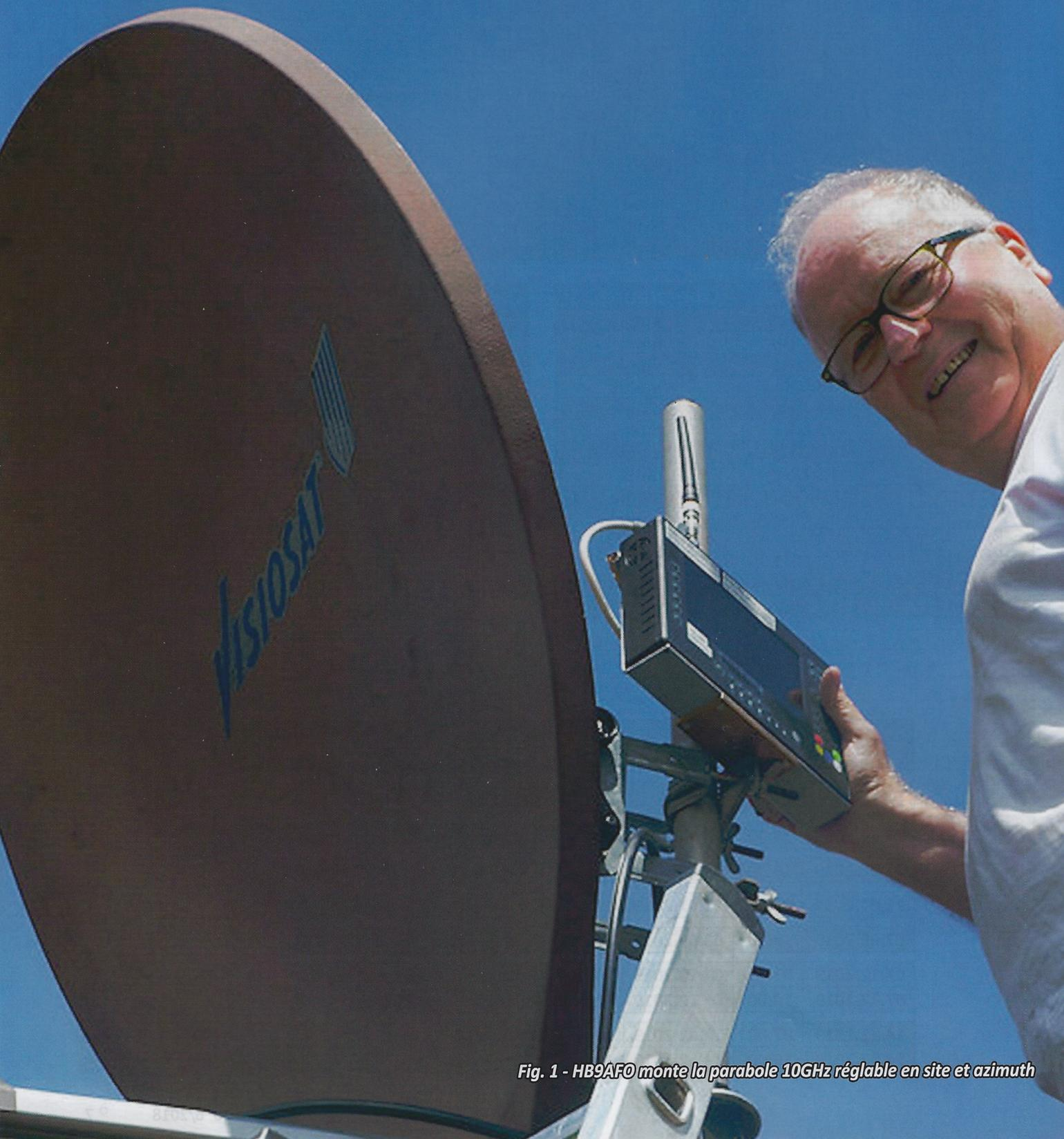
*Fig. 1 - HB9AFO monte la parabole 10GHz réglable en site et azimuth*
