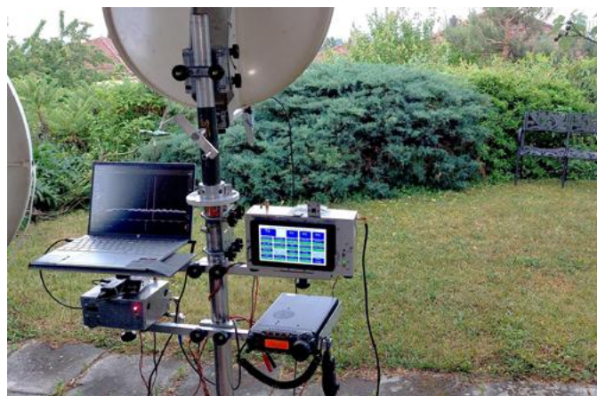
Fig 1 : L'ensemble portable émission-réception DATV 24 GHz
