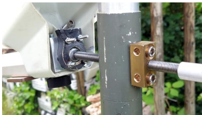
Fig 7 : Réglage du site de la parabole avec la butée-rotule de Vampire
