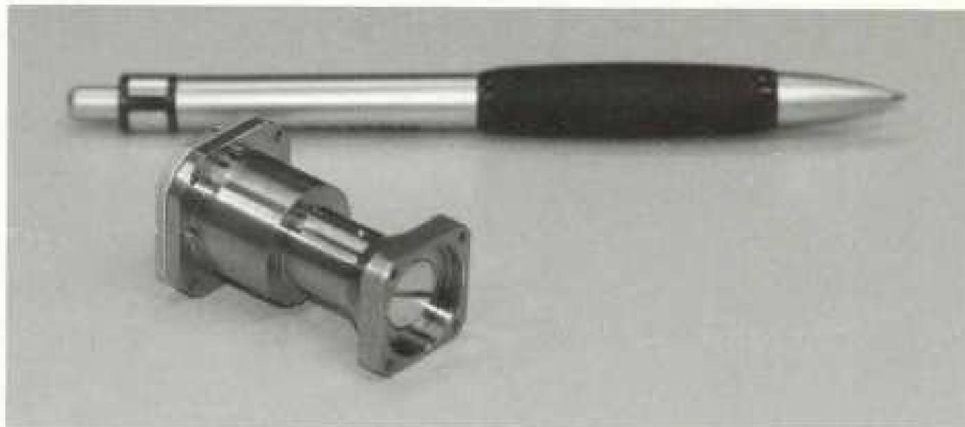
*Le payload de SwissCube: le télescope. – Das Teleskop von SwissCube, mit dessen Hilfe das Phänomen des Luftglühens untersucht werden soll.*
