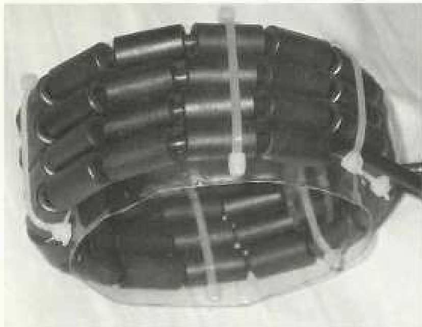
Figure 6: Le balun enroulé sur son support.
