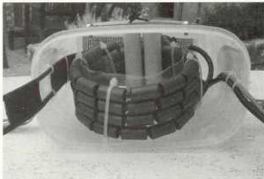
Figure 7: La boîte vue de dessous (avant montage). On distingue la platine au fond et le câble de contrôle des relais en gris à droite.
