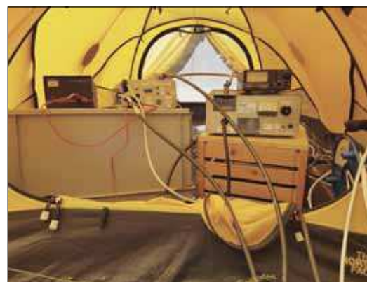
Le système complet avec alimentation, driver, PA 2C39 installé sous une tente au pied des antennes.
