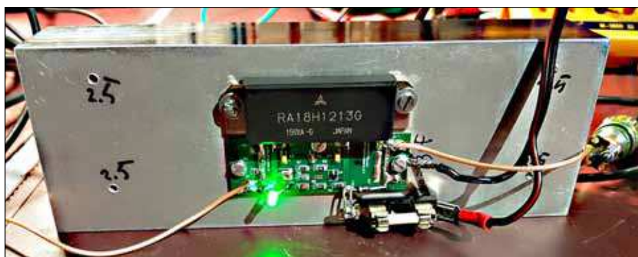
Test du module de puissance RA18H1213G monté sur son radiateur
