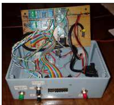
Vue intérieur de boîtier de télécommande en cours de montage
