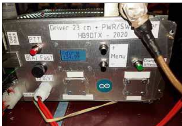
Le driver dans son boîtier en test avec le PA 2C39 connecté. Tout fonctionne!
