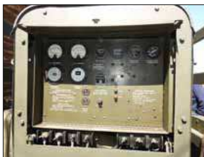
Générateur PE 95 110/220 V 60 Hz 10 kW
