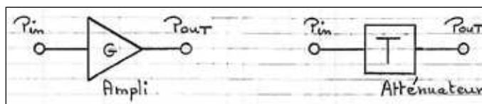
Fig. 2: Ampli et atténuateur; schémas bloc
