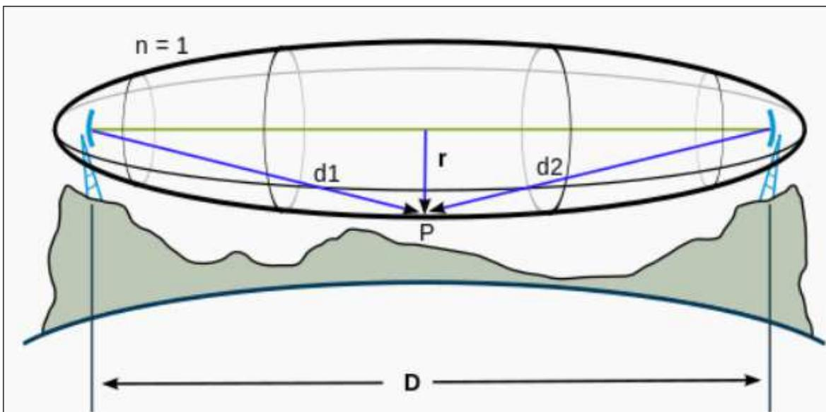
Fig. 1: Zone de Fresnel;  $D$  est la distance entre TX et RX,  $r$  est le rayon de l'ellipse de Fresnel
