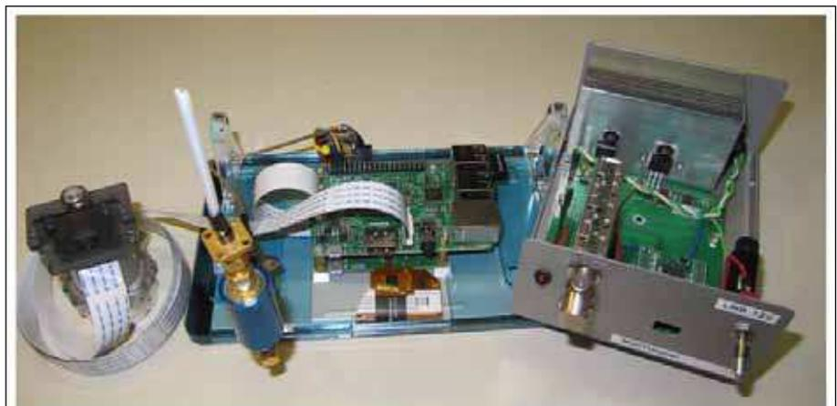
Figure 8: Raspberry Pi en émission et MiniTionner en réception DVB-S sur 23 cm (Source: HB9DUG)
