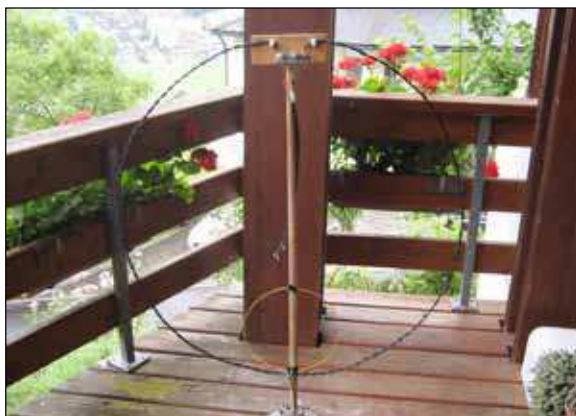
La loop se compose de 3 fils tressés [Fotos: HB9CAB]
