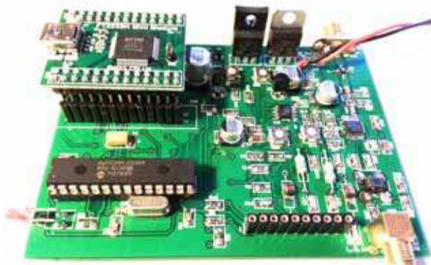
Figure 5: DATV mittels PC: vom BATC entwickelte Karte mit USB-Interface und QSPK-Modulator [Foto: HB9DUG]
