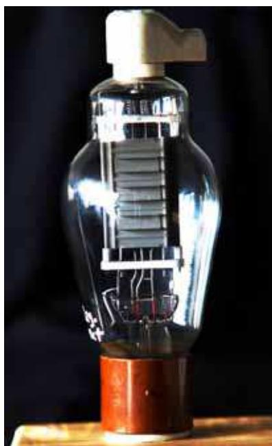
**Bild 3: 811-A von RCA, mit primitiv verstärkter Anode**
