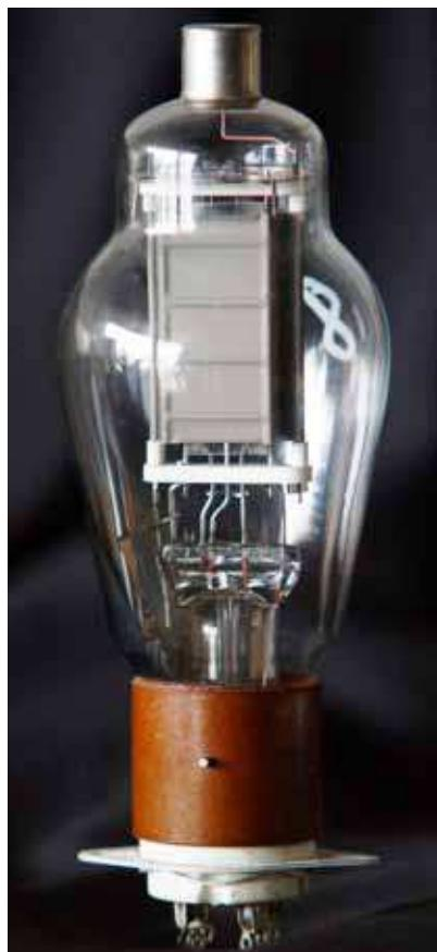
**Bild 2: Alte 811 mit simpler Blechanode (1939)**
