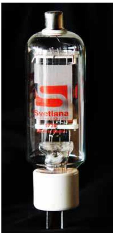
**Image 5: 572-B Moderne de fabrication Svetlana avec belle anode de graphite et ballon en verre trempé; puissance anode dissipée 160W**
