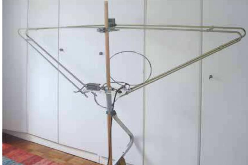
**Photo 1: Vue générale de l'antenne magnétique compacte 80 m**
