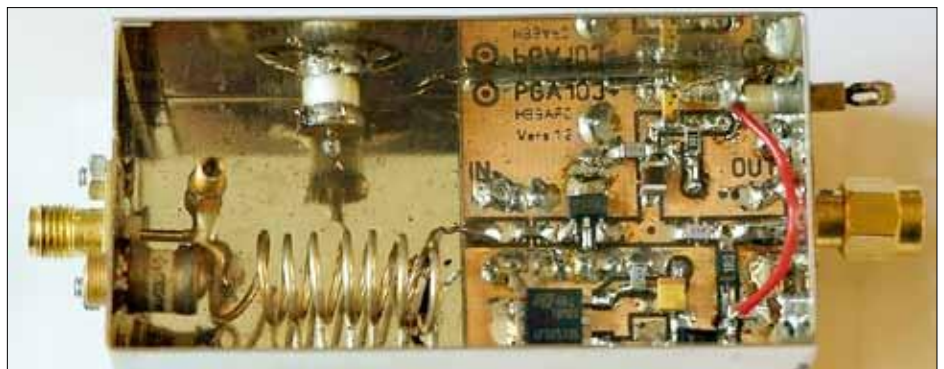
Fig 12: Le préampli 144 qui a gagné le contest de la réunion EME 2014
