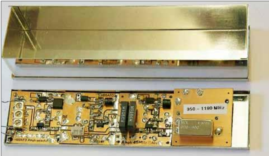
Fig 2: Montage de plusieurs modules dans un boîtier Schubert
