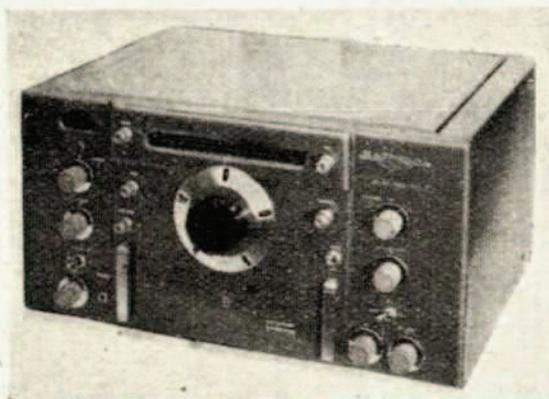
**Die Mischstufe** arbeitet aus Gründen der Rauschmutter additiv mit getrenntem Oszillator, der in Eco-Schaltung die größte Stabilität besitzt. Schon die erste Ausführung verzichtete auf die herkömmliche Pentagrid- oder Hexodenmischung und verwendete eine Pentode mit Einkopplung der Oszillatorfrequenz auf das Schirmgitter — für die damalige Zeit entschieden ungewöhnlich.
