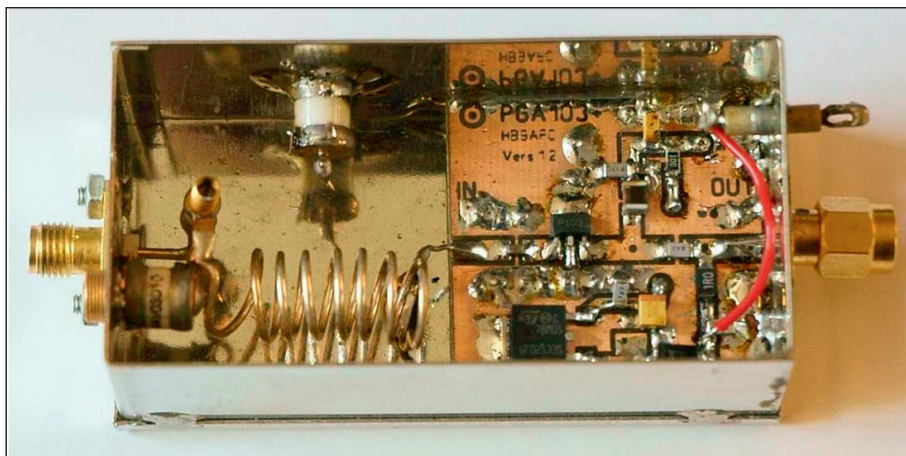
Figure 3 : Ampli 144 MHz à faible bruit et forte tenue aux signaux élevés
